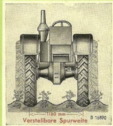
Das große Rad des LANZ-Allzweck-Bulldog bringt für den Schlepper-Betrieb viele Vorteile, denn Schlepper-Schlupf und Bodendruck werden vermindert und mit der großen Auflage und der Griffigkeit der Räder wird eine ideale Übersetzung der Motorkraft in Zugleistung erreicht, auch bei schwierigen Untergrundverhältnissen wie Sand
